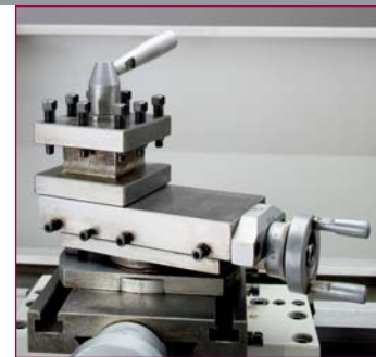
Drehbarer Oberschlitten für das Kegel- und Kugeldrehen
