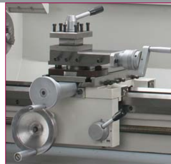
Leichtgängiger Werkzeugschlitten mit nachstellbaren Keilleisten
