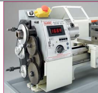
Hoch belastbarer Antrieb mit Präzisions-Zahnradern
