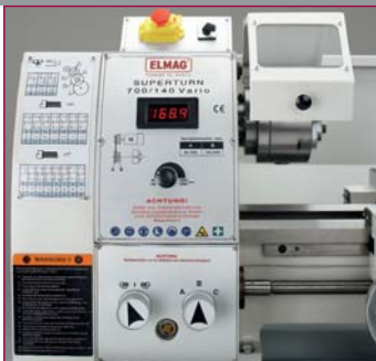
Übersichtliches Bedienfeld mit digitaler Drehzahlanzeige
