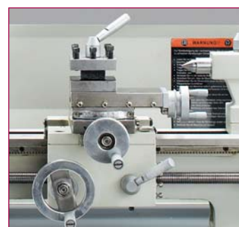
Präziser Werkzeugschlitten mit Längs-/Leitspindel
