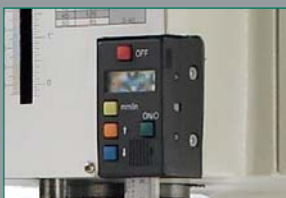
Optimal: Digitalanzeige für Bohrtiefe
