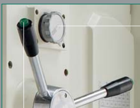
Dreifach-Bedienhebel mit Schaltelementen für automatischen Pinolenvorschub oder Drehrichtungsumkehr (Gewindeschneidmodus)
