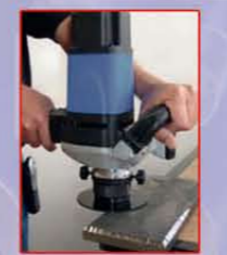
Velseitiges Entgraten und Anfasen von Konturen, Radien und engen Bohrungen, 30° Schweißnaht- & Sichtkantenvorbereitung etc.
