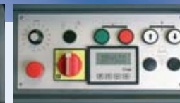
Bedienungseinheit mit den Optionen: Digitaler Gehrungswinkel (schnelles und exaktes Ablesen der Winkel, Anzeige 0,1°), Stufenlose Drehzahlverstellung durch Frequenzumformer. Hydraulisches Heben und Senken des Sägerahmens.
