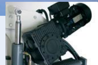
Kompaktgetriebe - großzügig ausgelegter Sägebandantrieb schafft Leistungsreserven.
