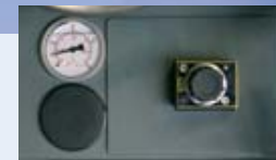
Option hydraulische Schnittdrucksteuerung: Exakte Steuerung des Sägerahmens durch ein feinfühlige einstellbares Stromregelventil.
