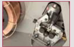
4-Rollen-Drahtvorschub-Motor mit Zahnradantrieb
