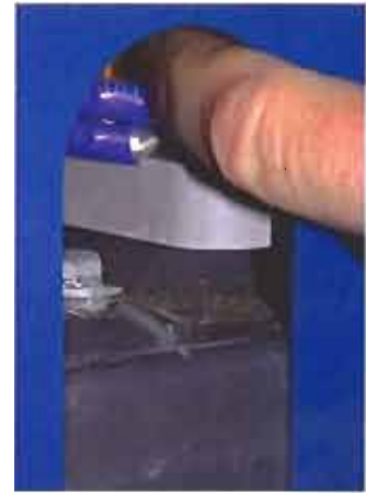
Abbildung 5: Gefahr – Zugang zu den Generatorklemmen ohne Werkzeug möglich!
