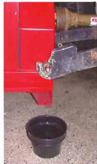
◀ Abbildung 3: Ein kleiner Schutzhohlfass wird immer abmontiert oder es werden Gelenkwellen ohne Gelenkwelenschutz verwendet.
