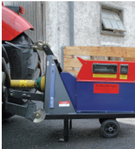
▲ Transportrollen, Stützfüße und Tragegriffe (hier abgeklappt) erleichtern die Manipulation.
