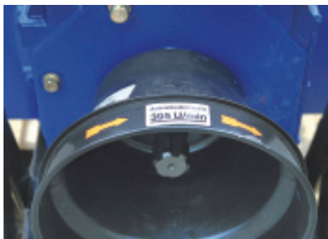
▲ Zapfwellenschutztopf mit Angabe der Drehzahl und Drehrichtung.
