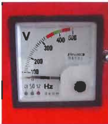
Abbildung 4: Frequenzanzeige mit Leuchtdioden (Filippini)
